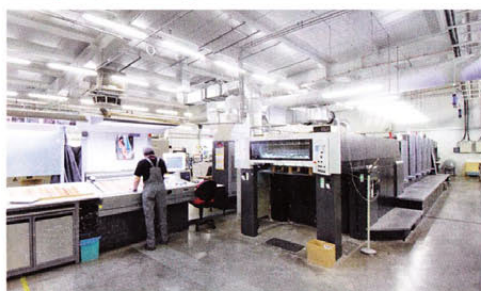
Tiskový stroj Heidelberg CD 102 5+L
