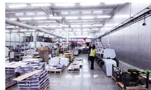
Šicí linka na vazbu V1 Heidelberg ST450
